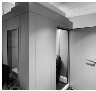
RAJAH 5a. Contoh sangkar faraday ( Faraday Cage, Outside ) yang terdapat di Monash University, Malaysia (gambar koleksi penulis)
