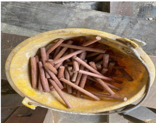
RAJAH 4. Pasak yang Dicipta oleh Tukang Timbal Perahu daripada Kayu Cengal di Terengganu bagi Menggantikan Paku
