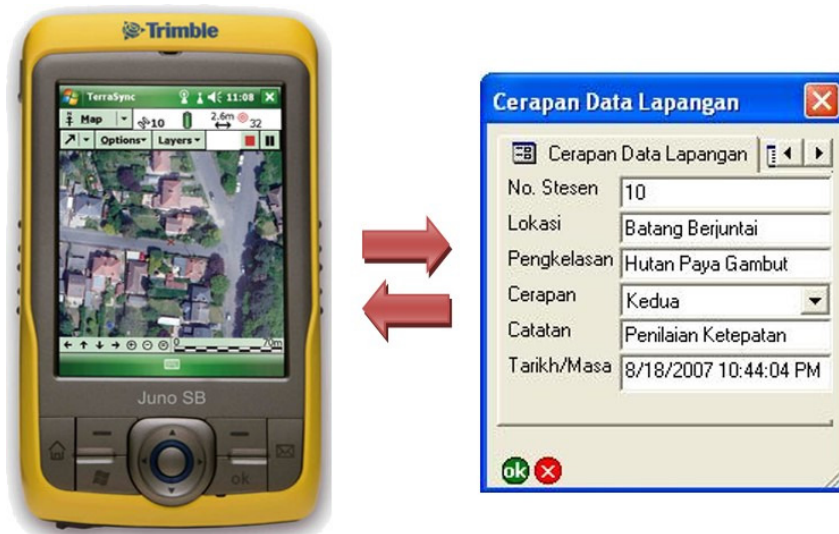
Rajah 3. Perkakasan GPS serta proses kemasukan data cerapan di lapangan
