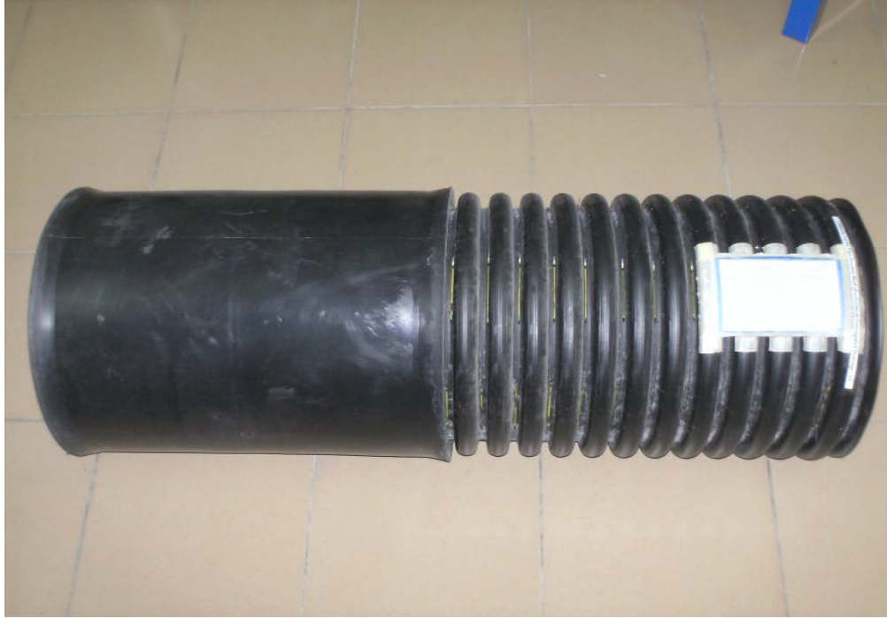
Foto 2. Paip HDPE double wall (perforated) yang ditanam di bawah tanah untuk memerangkap air lelehan
