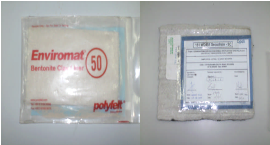
Foto 3. Tanah liat sintetik GLCS (Bentofix NSP 4000) dan pelapik WD 451 Secudrain yang digunakan sebagai penyalut dan pelapik paip
